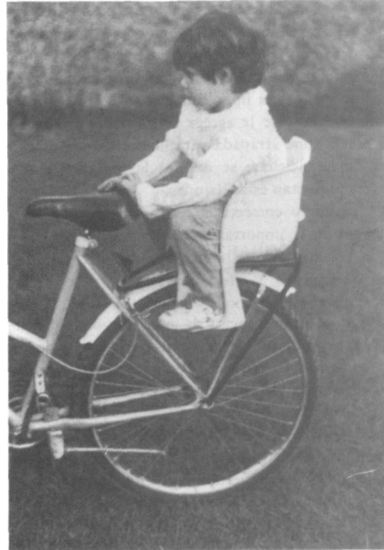
Fig. 5. Mecanismo de resguardo con protector plástico.
