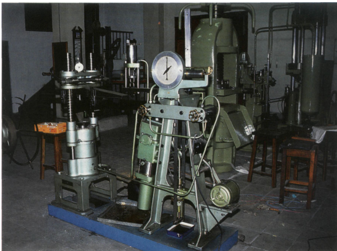
Fig. 1. Prensa hidráulica AMSLER, de 30 toneladas de capacidad (gentileza del Departamento de Estructuras y Materiales, Facultad de Ingeniería, UBA).
