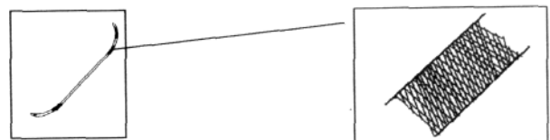
Figura 1. Clavo de Ender antimigratorio corrugado en los puntos de apoyo.
