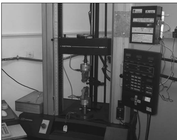
Figura 3. Máquina utilizada para la prueba de resistencia mecánica a la tracción (modelo 4487, Instron, Canton; Massachussets).
