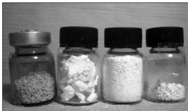
Figura 5. Diferentes tipos de biocerámicos. De izquierda a derecha: HA-20βTCP, HA cortical, HA 300 a 600 μm - HA-40βTCP.
