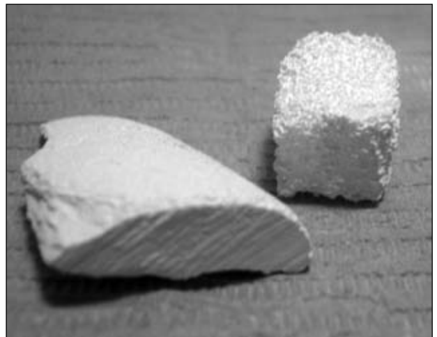
Figura 1. Hidroxiapatita densa de tipo cortical e hidroxiapatita esponjosa.
