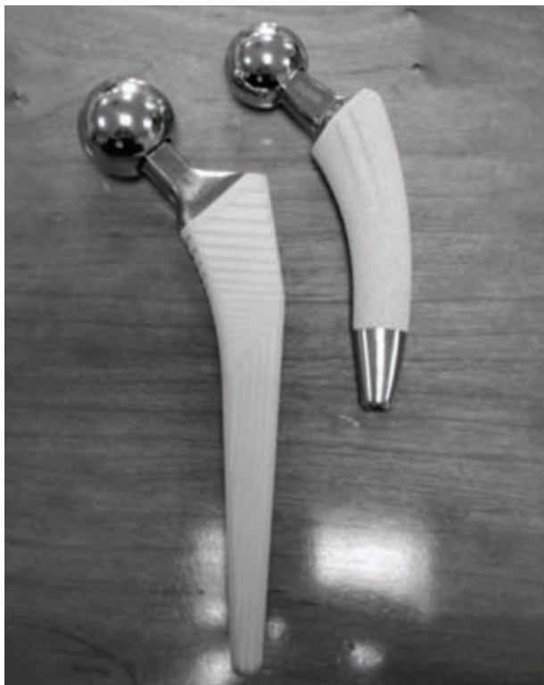
Figura 1. Se muestran los dos implantes medidos: el tallo de fijación cervicometafisaria (a la derecha) y el tallo de fijación metafisodiafisaria (a la izquierda).
